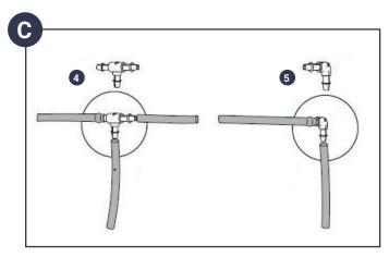
Positionnez les tuyaux avec les goutteurs le long des rangs de cultures et si besoin utilisez les jonctions Té ou coudées cannelées Ø 8mm.
