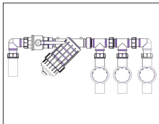
Écrous tournants Tavit 2" et filtre 2" installés en tête de système.
