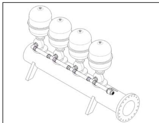
Écrous tournants Tavit 2" utilisés comme manifold de contre lavage sur batterie de filtration.
