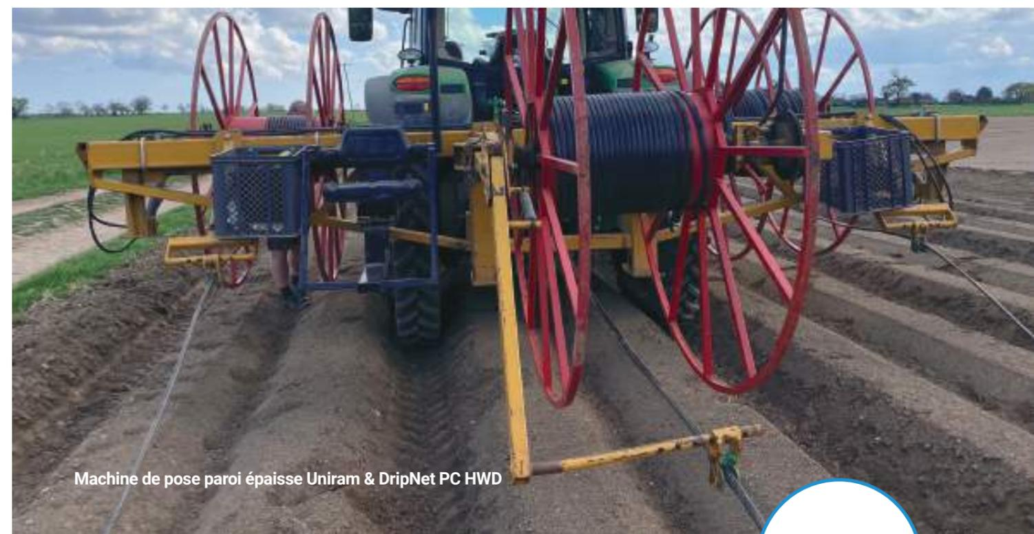
Machine de pose paroi épaisse Uniram & DripNet PC HWD
